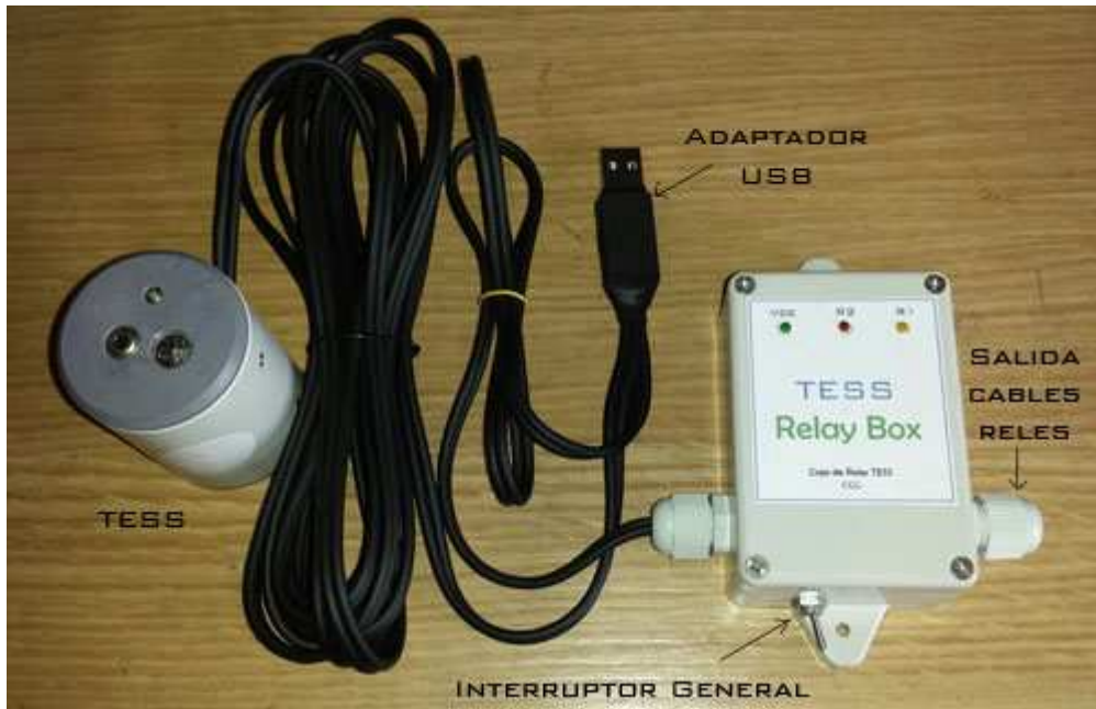
Del adaptador USB salen cables hacia el TESS y la caja de relés.
