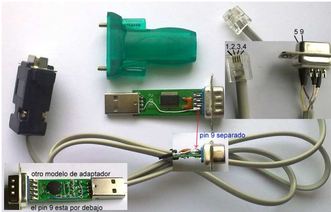
Adaptador USB-RS232 clónico modificado para tomar los 5v de alimentación para el módulo.
