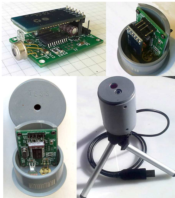
La versión TTL con adaptador USB externo y bluetooth en un manguito de PVC de 40mm.
